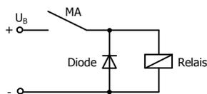
Unterdrückung von Spannungsspitzen mit einer Freilaufdiode
