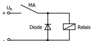
Unterdrückung von Spannungsspitzen mit einer Freilaufdiode
