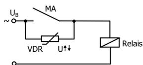
Unterdrückung von Spannungsspitzen mit einem VDR
