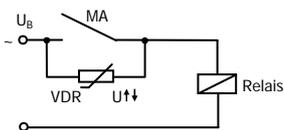
Unterdrückung von Spannungsspitzen mit einem VDR
