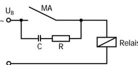
Unterdrückung von Spannungsspitzen mit einem RC-Glied
