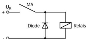
Unterdrückung von Spannungsspitzen mit einer Freilaufdiode
