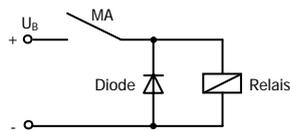
Unterdrückung von Spannungsspitzen mit einer Freilaufdiode
