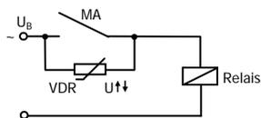
Unterdrückung von Spannungsspitzen mit einem VDR
