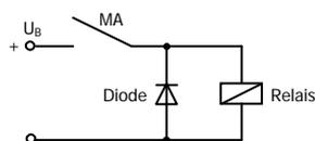
Unterdrückung von Spannungsspitzen mit einer Freilaufdiode
