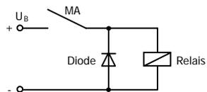
Unterdrückung von Spannungsspitzen mit einer Freilaufdiode
