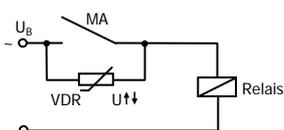
Unterdrückung von Spannungsspitzen mit einem VDR
