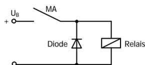
Unterdrückung von Spannungsspitzen mit einer Freilaufdiode
