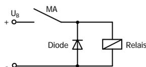
Unterdrückung von Spannungsspitzen mit einer Freilaufdiode
