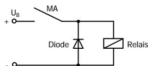
Unterdrückung von Spannungsspitzen mit einer Freilaufdiode
