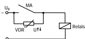
Unterdrückung von Spannungsspitzen mit einem VDR
