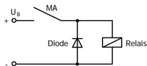
Unterdrückung von Spannungsspitzen mit einer Freilaufdiode
