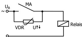
Unterdrückung von Spannungsspitzen mit einem VDR
