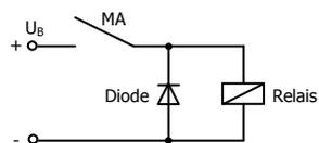
Unterdrückung von Spannungsspitzen mit einer Freilaufdiode
