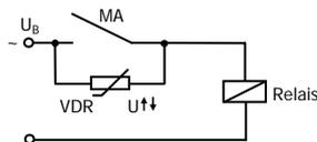
Unterdrückung von Spannungsspitzen mit einem VDR
