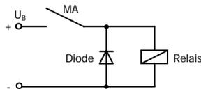
Unterdrückung von Spannungsspitzen mit einer Freilaufdiode
