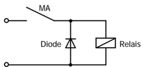
Unterdrückung von Spannungsspitzen mit einer Freilaufdiode
