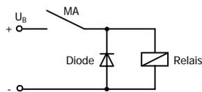
Unterdrückung von Spannungsspitzen mit einer Freilaufdiode
