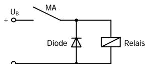
Unterdrückung von Spannungsspitzen mit einer Freilaufdiode
