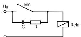
Unterdrückung von Spannungsspitzen mit einem RC-Glied
