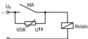
Unterdrückung von Spannungsspitzen mit einem VDR
