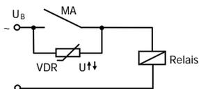
Unterdrückung von Spannungsspitzen mit einem VDR
