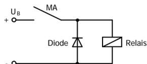
Unterdrückung von Spannungsspitzen mit einer Freilaufdiode
