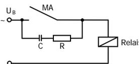
Unterdrückung von Spannungsspitzen mit einem RC-Glied
