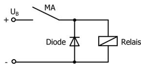
Unterdrückung von Spannungsspitzen mit einer Freilaufdiode
