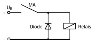
Unterdrückung von Spannungsspitzen mit einer Freilaufdiode
