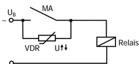
Unterdrückung von Spannungsspitzen mit einem VDR
