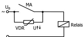
Unterdrückung von Spannungsspitzen mit einem VDR
