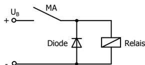
Unterdrückung von Spannungsspitzen mit einer Freilaufdiode
