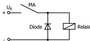
Unterdrückung von Spannungsspitzen mit einer Freilaufdiode
