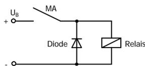
Unterdrückung von Spannungsspitzen mit einer Freilaufdiode
