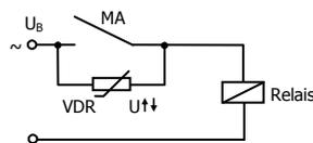
Unterdrückung von Spannungsspitzen mit einem VDR
