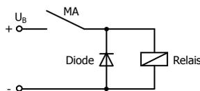
Unterdrückung von Spannungsspitzen mit einer Freilaufdiode
