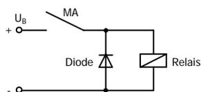
Unterdrückung von Spannungsspitzen mit einer Freilaufdiode
