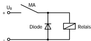
Unterdrückung von Spannungsspitzen mit einer Freilaufdiode
