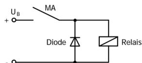
Unterdrückung von Spannungsspitzen mit einer Freilaufdiode
