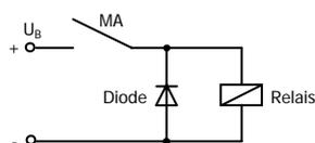
Unterdrückung von Spannungsspitzen mit einer Freilaufdiode
