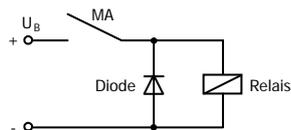
Unterdrückung von Spannungsspitzen mit einer Freilaufdiode
