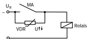
Unterdrückung von Spannungsspitzen mit einem VDR
