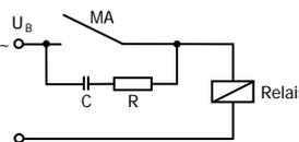
Unterdrückung von Spannungsspitzen mit einem RC-Glied
