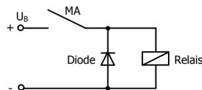
Unterdrückung von Spannungsspitzen mit einer Freilaufdiode
