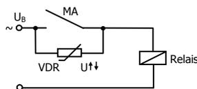
Unterdrückung von Spannungsspitzen mit einem VDR
