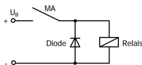
Unterdrückung von Spannungsspitzen mit einer Freilaufdiode
