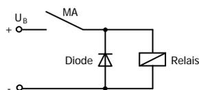
Unterdrückung von Spannungsspitzen mit einer Freilaufdiode
