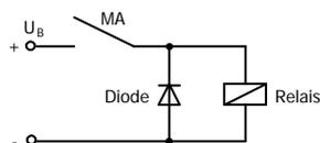
Unterdrückung von Spannungsspitzen mit einer Freilaufdiode
