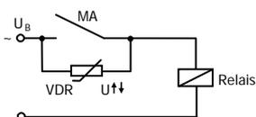
Unterdrückung von Spannungsspitzen mit einem VDR
