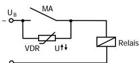
Unterdrückung von Spannungsspitzen mit einem VDR
