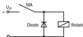
Unterdrückung von Spannungsspitzen mit einer Freilaufdiode
