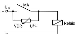
Unterdrückung von Spannungsspitzen mit einem VDR
