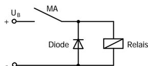
Unterdrückung von Spannungsspitzen mit einer Freilaufdiode
