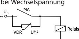
Unterdrückung von Spannungsspitzen mit einem VDR
