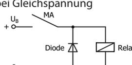
Unterdrückung von Spannungsspitzen mit einer Freilaufdiode
