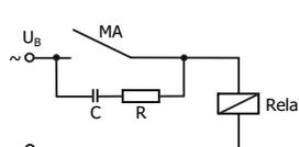
Unterdrückung von Spannungsspitzen mit einem RC-Glied
