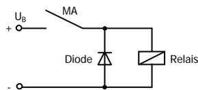
Unterdrückung von Spannungsspitzen mit einer Freilaufdiode
