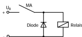
Unterdrückung von Spannungsspitzen mit einer Freilaufdiode
