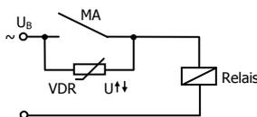
Unterdrückung von Spannungsspitzen mit einem VDR
