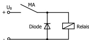
Unterdrückung von Spannungsspitzen mit einer Freilaufdiode
