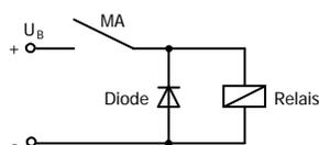
Unterdrückung von Spannungsspitzen mit einer Freilaufdiode
