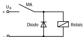
Unterdrückung von Spannungsspitzen mit einer Freilaufdiode
