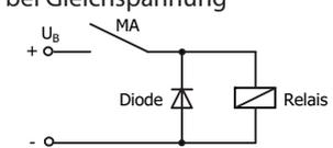
Unterdrückung von Spannungsspitzen mit einer Freilaufdiode
