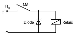
Unterdrückung von Spannungsspitzen mit einer Freilaufdiode
