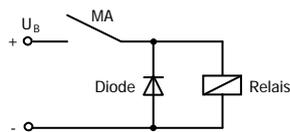
Unterdrückung von Spannungsspitzen mit einer Freilaufdiode
