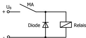
Unterdrückung von Spannungsspitzen mit einer Freilaufdiode
