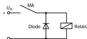
Unterdrückung von Spannungsspitzen mit einer Freilaufdiode
