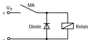
Unterdrückung von Spannungsspitzen mit einer Freilaufdiode
