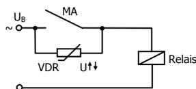
Unterdrückung von Spannungsspitzen mit einem VDR
