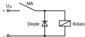
Unterdrückung von Spannungsspitzen mit einer Freilaufdiode
