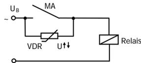
Unterdrückung von Spannungsspitzen mit einem VDR
