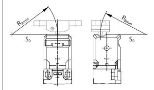
R<sub>Amin</sub> und R<sub>Bmin</sub> sind abhängig vom Betätiger. Gilt entsprechend auch für seitliche Einfahrrichtungen.
