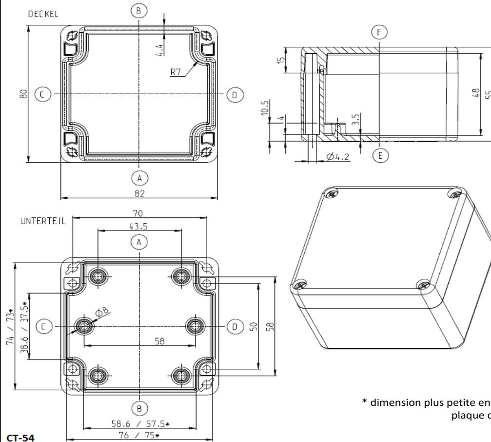
\* dimension plus petite en hauteur surface d'appui de la plaque de montage
